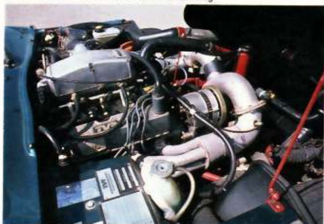
Eine Motorhaube wie ein Buckelwal; der Rover-Motor erfordert eine umständliche Krümmerführung
